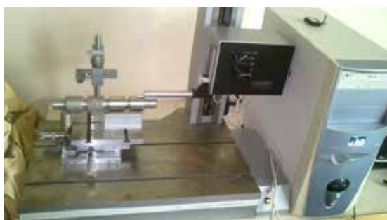
Рис. 4. Визначення шорсткості на приладі профілограф-профілометр мод. 201 заводу «Калібр»: а – фото приладу; б – профілограма шорсткості вихідного зразка
