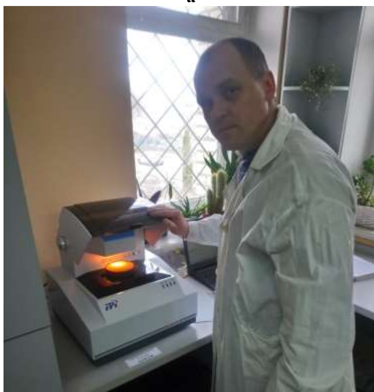
Рис. Визначення вмісту олії на інфрачервоному аналізаторі SupNir 2700: а – підготовка зразка для аналізу; б – проведення аналізу та збір даних
