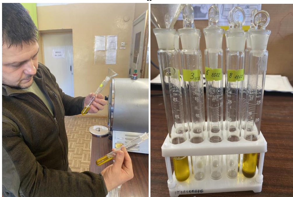
Рис. А.3. Визначення показників якості досліджуваних видів гірчиці: а – вміст вологи (воломір зерна HE Lite (Pfeuffer, Німеччина); б – вмісту олії (пресс ручний ПРОМ-1У)
