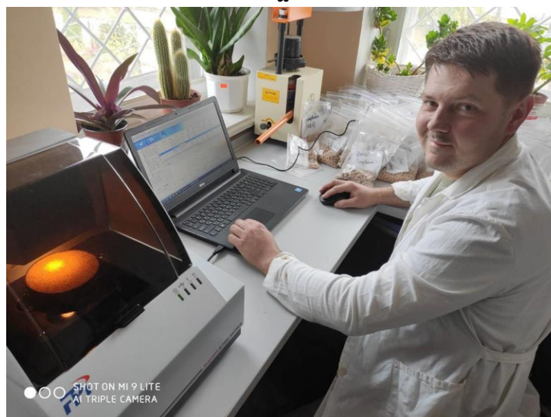
Рис. А.4. Визначення показників якості досліджуваних видів гірчиці: а – маси 1000 шт. насінин; б – вмісту олії та глюкозинолатів у насінні (пресс ручний ПРОМ-1У та інфрачервоний аналізатор SapNir 2700)
