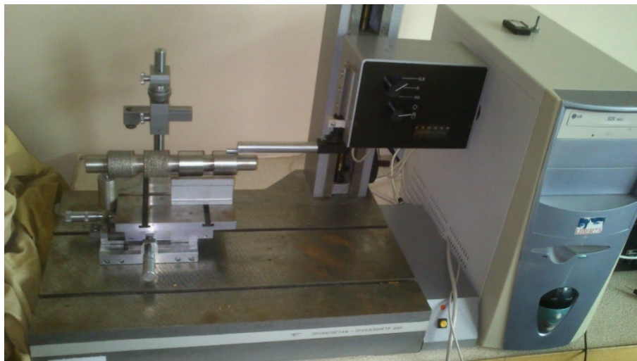
Рисунок 3.3 – Фотографія виміру шорсткості покриття на профілографі-профілометрі мод. 201.
