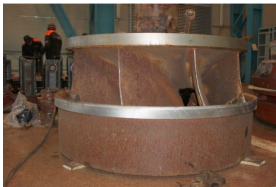
Рисунок 1.5 [40] – Руйнування поверхневих шарів робочого колеса турбіни в результаті корозії
