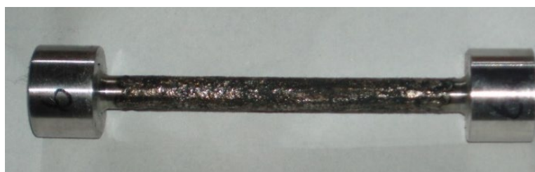
Рисунок 4.4 – Зразок для випробування на розрив.
