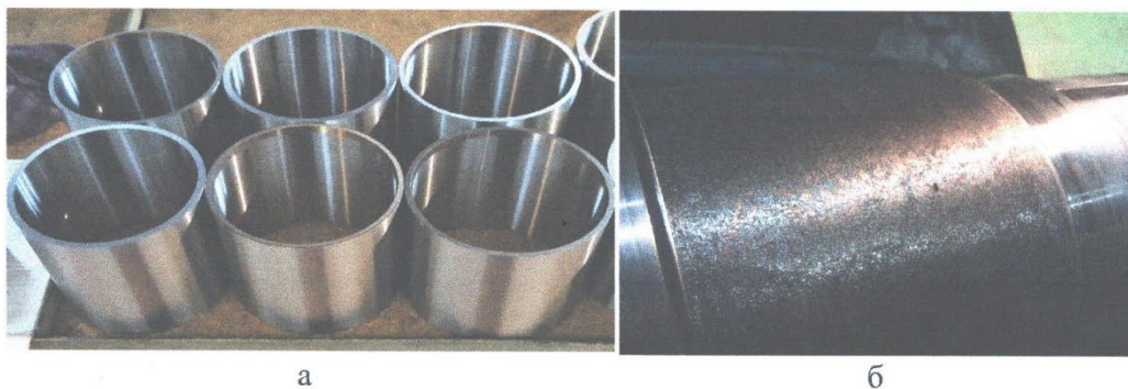
Рисунок 1 - Зовнішній вигляд ЗВ ущільнення до (а) і після (б) нанесення композиційного електроіскрового покриття.
