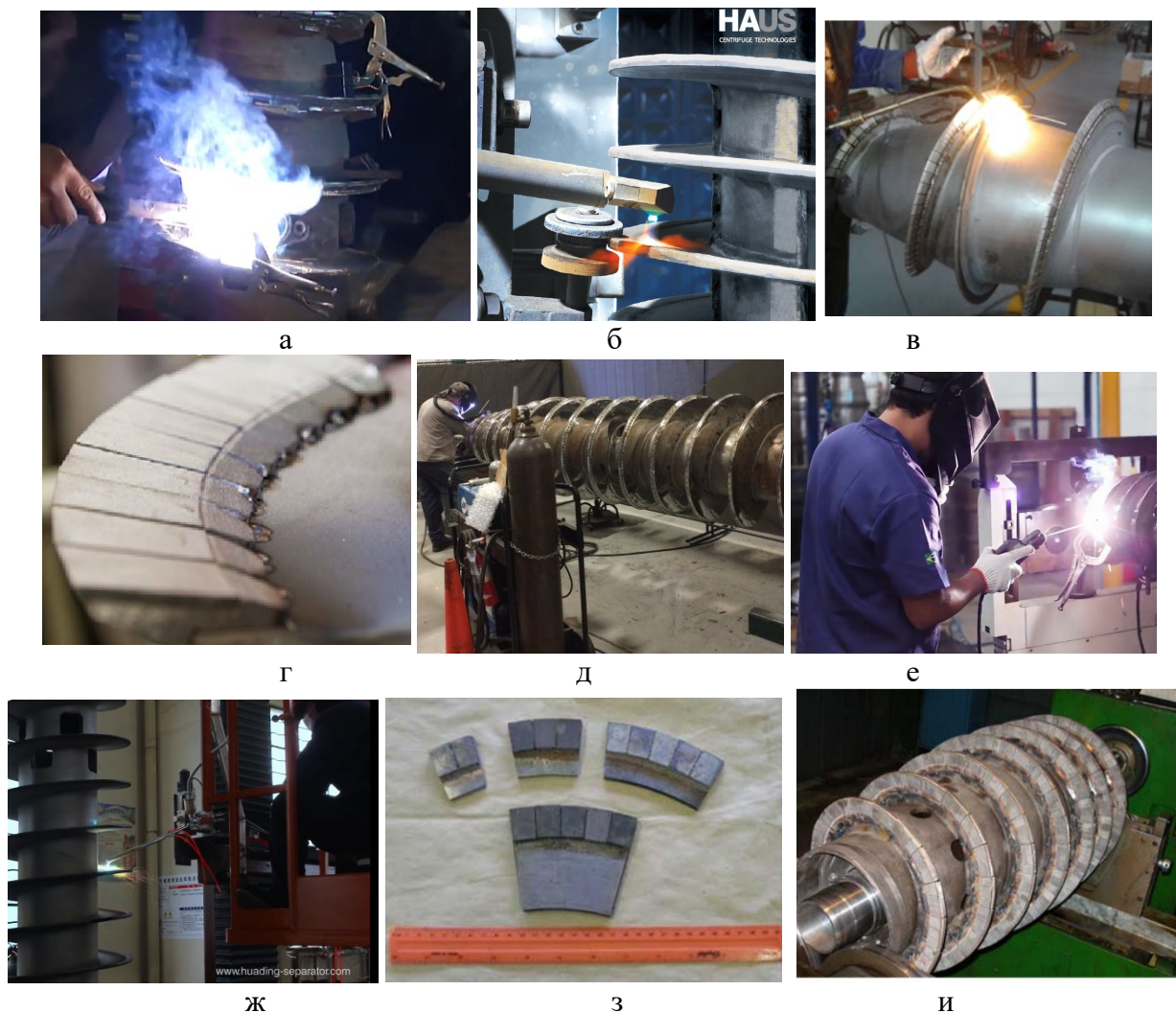
Рисунок 1 – Ремонт і зміцнення зношених ділянок шнеків центрифуг: а - зварювання сегментів і твердосплавних пластин на виробництві Rotating Equipmet Repair, LLC (США) [5]; б – нанесення покриттів з карбіду вольфраму шляхом плазмового напилення на виробництві HAUS (Туреччина) [6]; в – формування покриття або приварювання сегментів з твердосплавними пластинами на виробництві Spomasz Wronki - Grupa Ferrum Sp. z o.o. (Польща) [7]; г – приварювання до шнеку лопаток з твердосплавними пластинами на виробництві Sabaros S.A. (Швейцарія) [8]; д – формування зносостійких покриттів на виробництві Pinnacle Industrial Services (Канада) [9]; ж - автоматизоване газополум'яне напилення зносостійкого покриття на виробництві HUADING MACHINERY CO., LTD. (Китай) [10]; з, и - формуванням краю гвинтів шнека секторами з твердосплавними пластинами шляхом зварюванням на виробництві Fluitech Systems (Україна, м.Суми) [11].
