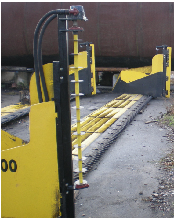
Рисунок 5 – Конструкція активного подільника жатки з горизонтально розташованими дисковими ножами.
