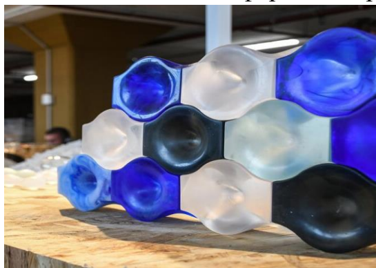
Рис. 12. Приклад будівельних матеріалів, що виготовлені з переробленого литого скла
