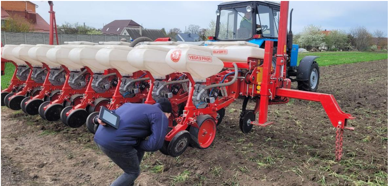
Рисунок 3.8 – Загальний вигляд машинно-тракторного агрегату МТЗ-82 та модернізована сівалка Vega 8 Profi під час закладання польових дослідів
