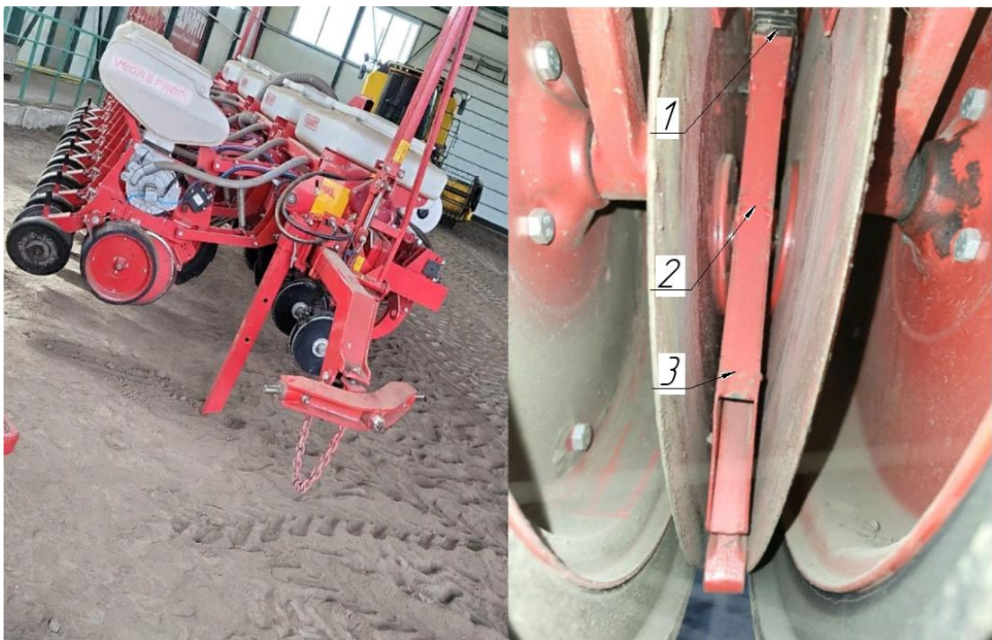
Рисунок. 1.7 – загальний вигляд (а) і висівна трубка секції (б) сівалки Elvorti Vega 8 Profi: 1 – сенсор визначення наявності насінини; 2 – висівна трубка; 3 – місце інтеграції форсунки.
