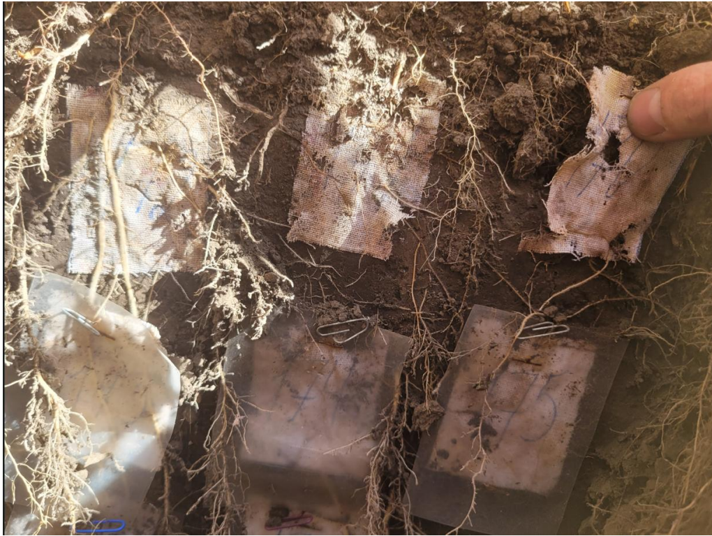
Рисунок 3.10 – Визначення біологічної активності ґрунту методом аплікацій (зразки лляної тканини)
