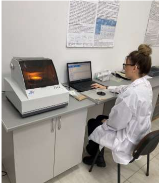
Рис. В.11. Визначення вмісту білка на інфрачервоному аналізаторі SupNir 2700: а – підготовка зразка для аналізу; б – проведення аналізу та збір даних
