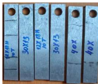
Рис. 2. Сталеві зразки для проведення дослідів на втомлювальну міцність
