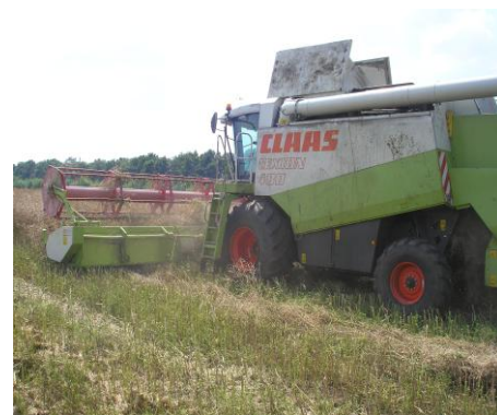
Рис 3. Пряме комбайнування ріпаку
