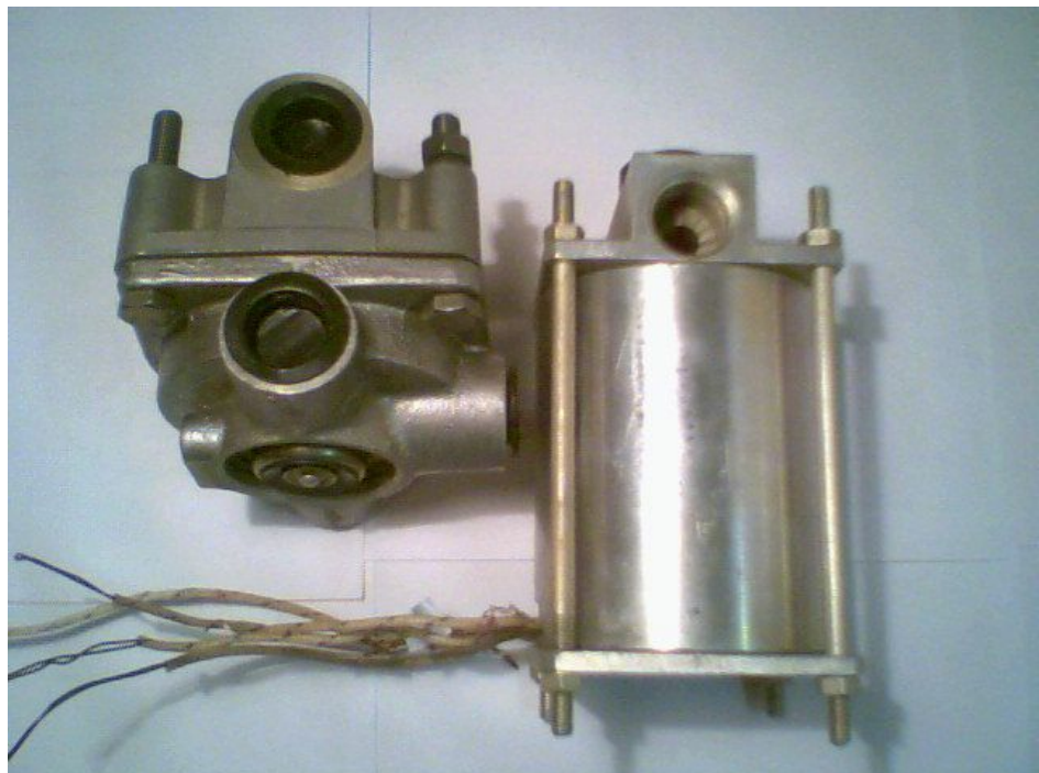
Рис. 3.11 Експериментальний зразок модулятора тиску у зібраному стані поруч з клапаном прискореної дії.
