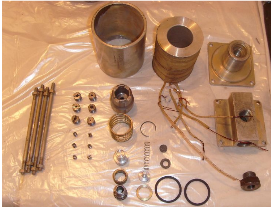
Рис. 3.10 Експериментальний зразок модулятора тиску в розібраному стані
