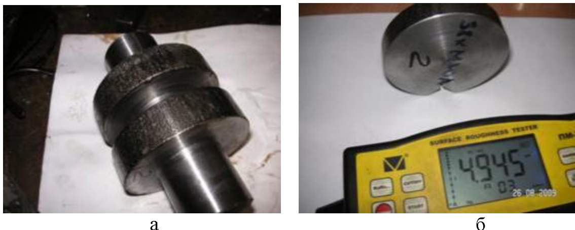
Рисунок 1 – Стальные образцы для исследования результатов ЦЭЭЛ
