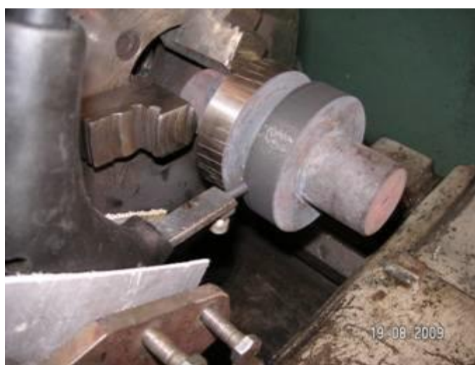
Рисунок 2 – ЦЭЭЛ с использованием токарного станка
