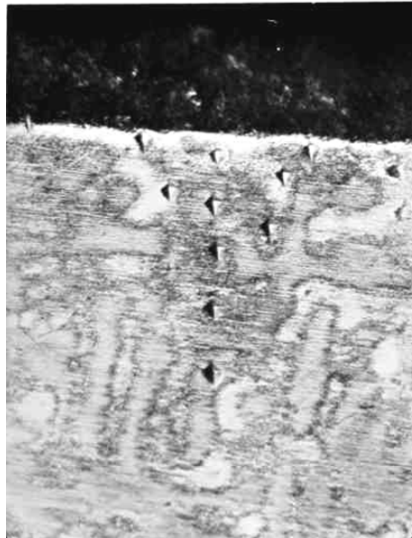
Рисунок 7 – Микроструктура и распределение микротвердости поверхностного слоя образца из бронзы ОЦС 5-5-5.
