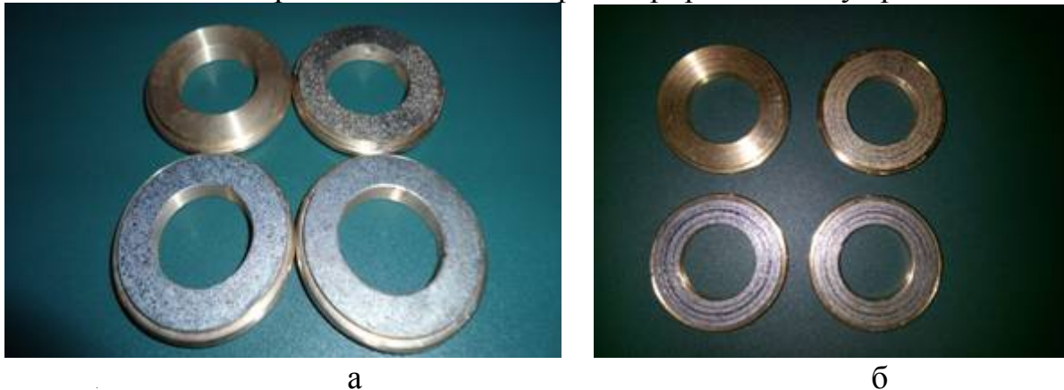
Рисунок 2 – Бронзовые образцы до (а) и после испытаний (б)
