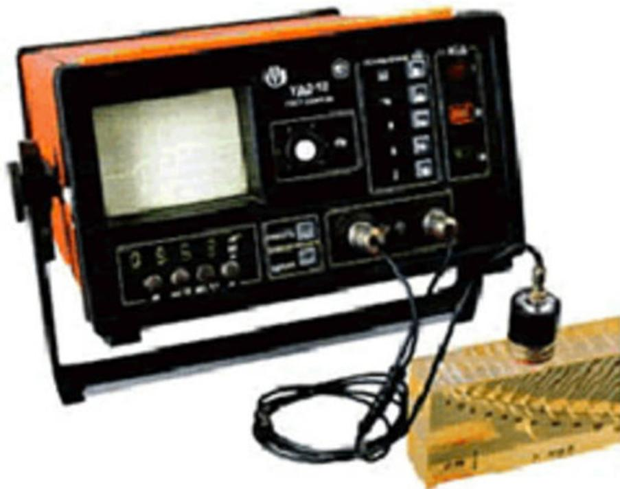
Рис. 2.1. - Общий вид ультразвукового дефектоскопа УД2-12
