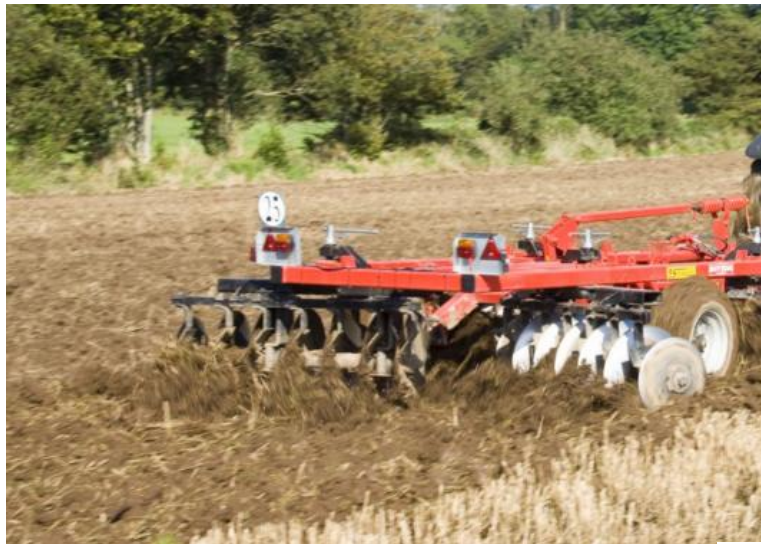
Рис. 1 – Робочий процес дискування ґрунту бороною Quivogne APXTL
