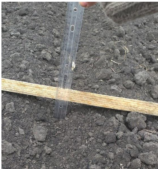
Рис. 5 – Визначення гребенистості поверхні ґрунту після дискування
