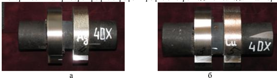
Рисунок 10 - Стальные образцы для исследования результатов ЦЭЛ и ЭЭЛ: а – серебром и б – медью.
