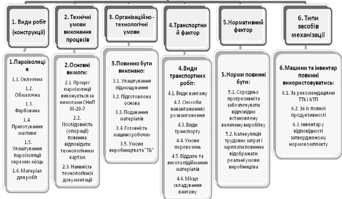
Рис. 3. Схема класифікації факторів, що впливають на технологічні показники витрат ресурсів та формування засобів малої механізації покрівельних робіт.
