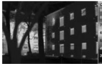
Рис.2 Фотографія в інфрачервоних променях показує, наскільки ефективна теплоізоляція пасивного будинку (праворуч) в порівнянні із звичайним будинком (ліворуч)
