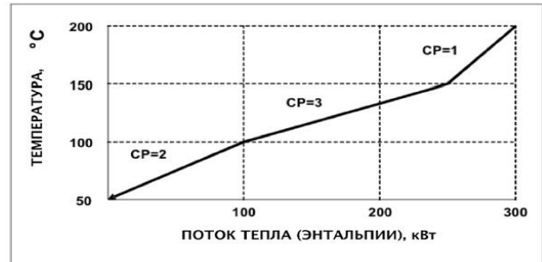
Рис.3. Графік сукупності двох гарячих потоків (так звана «гаряча складова крива»)
