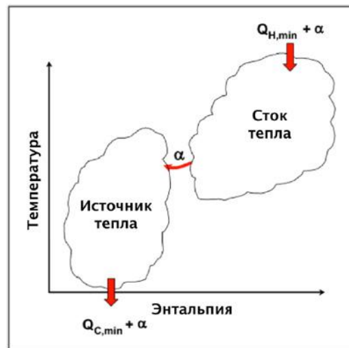
Рис.6. Схема компенсації теплоти, що передається через пінч.
