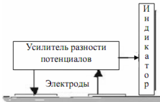
Рисунок 2. Схема измерения ЭКС
