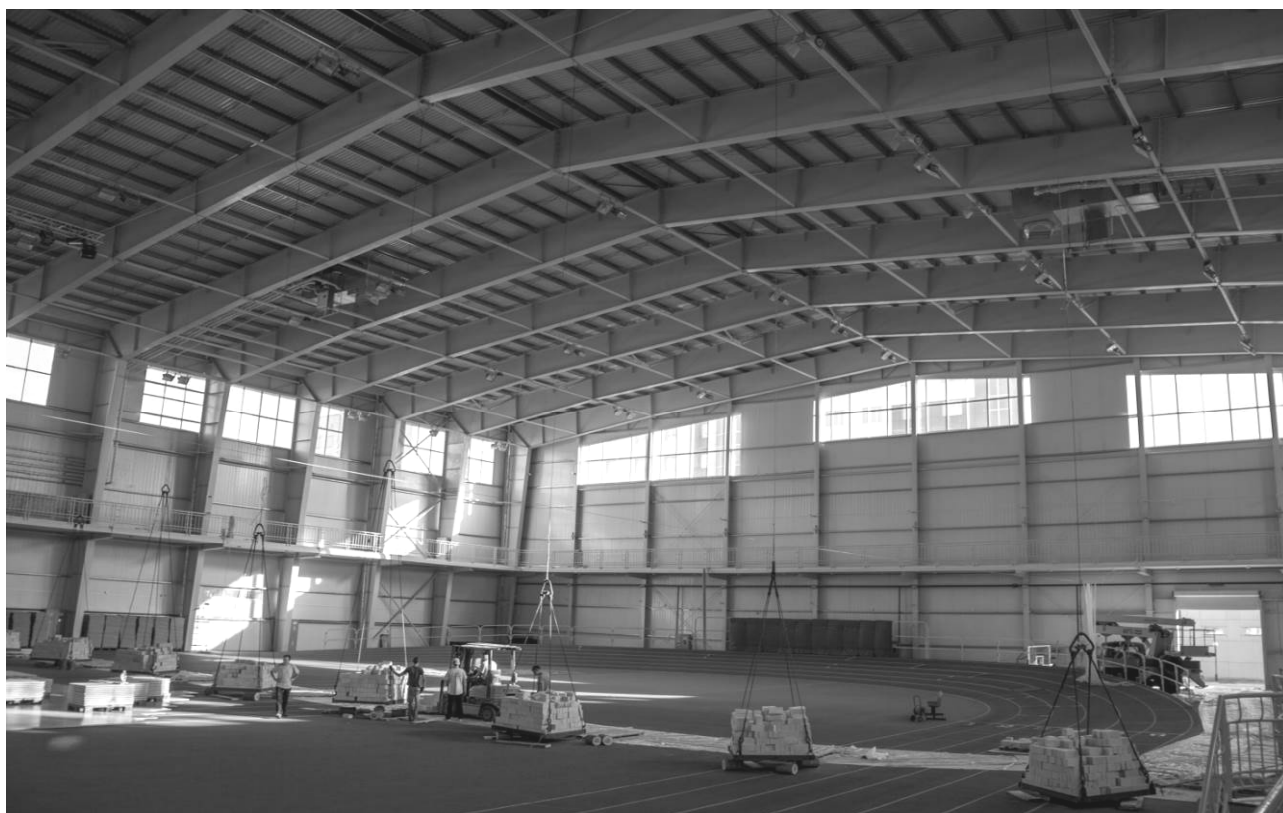
Рис. 4 Статичні випробування рами 5 ступеня при повній масі вантажів
