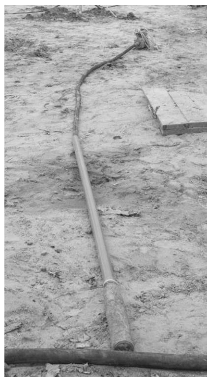
Рис.3 Обладнання для влаштування ґрунтоцементних фундаментів з високочастотним глибоким вібруванням: а – РДК-250 з навісним буровим обладнанням; б – глибокий вібратор ИВ-117 на гнучкому валу.
