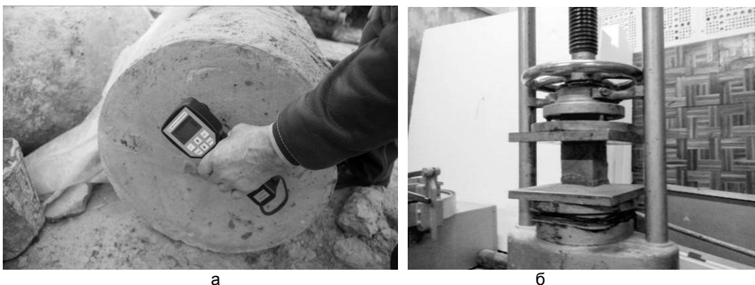
Рис. 8 Визначення міцності матеріалу паль: а – визначення міцності матеріалу за допомогою УКС-МГ4 на зрізі палі; б – визначення міцності відібраних зразків ґрунтоцементу за допомогою пресу.
