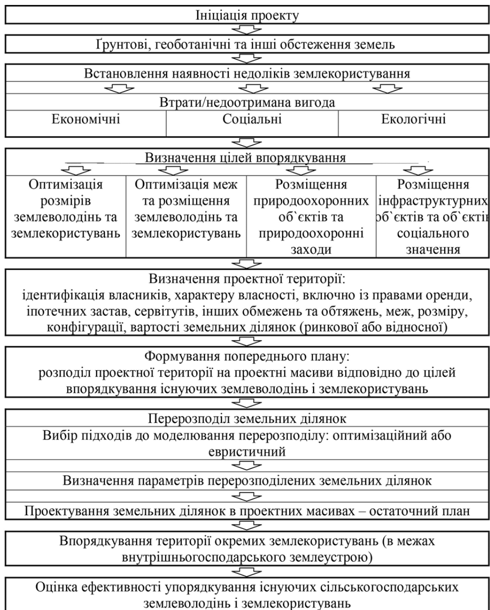
Рис. 1. Алгоритм перерозподілу земельних ділянок при впорядкуванні існуючих землеволодінь і землекористувань
