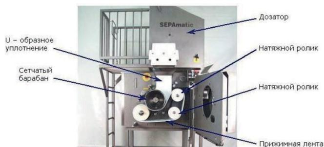
Рис. 4. Фото машины щадящего метода воздействия на мясное сырье «SEPAmatic»
