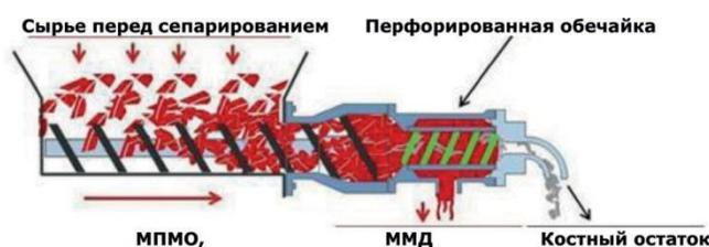
Рис. 1. Принципиальная схема работы шнекового сепаратора
