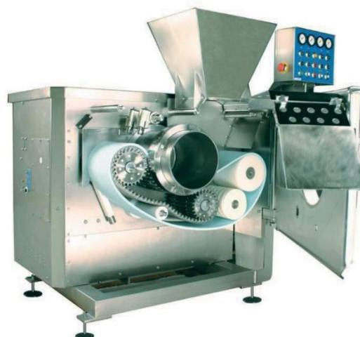
Рис. 5. Фото машины щадящего метода воздействия на мяскокостное сырье «Баадер»
