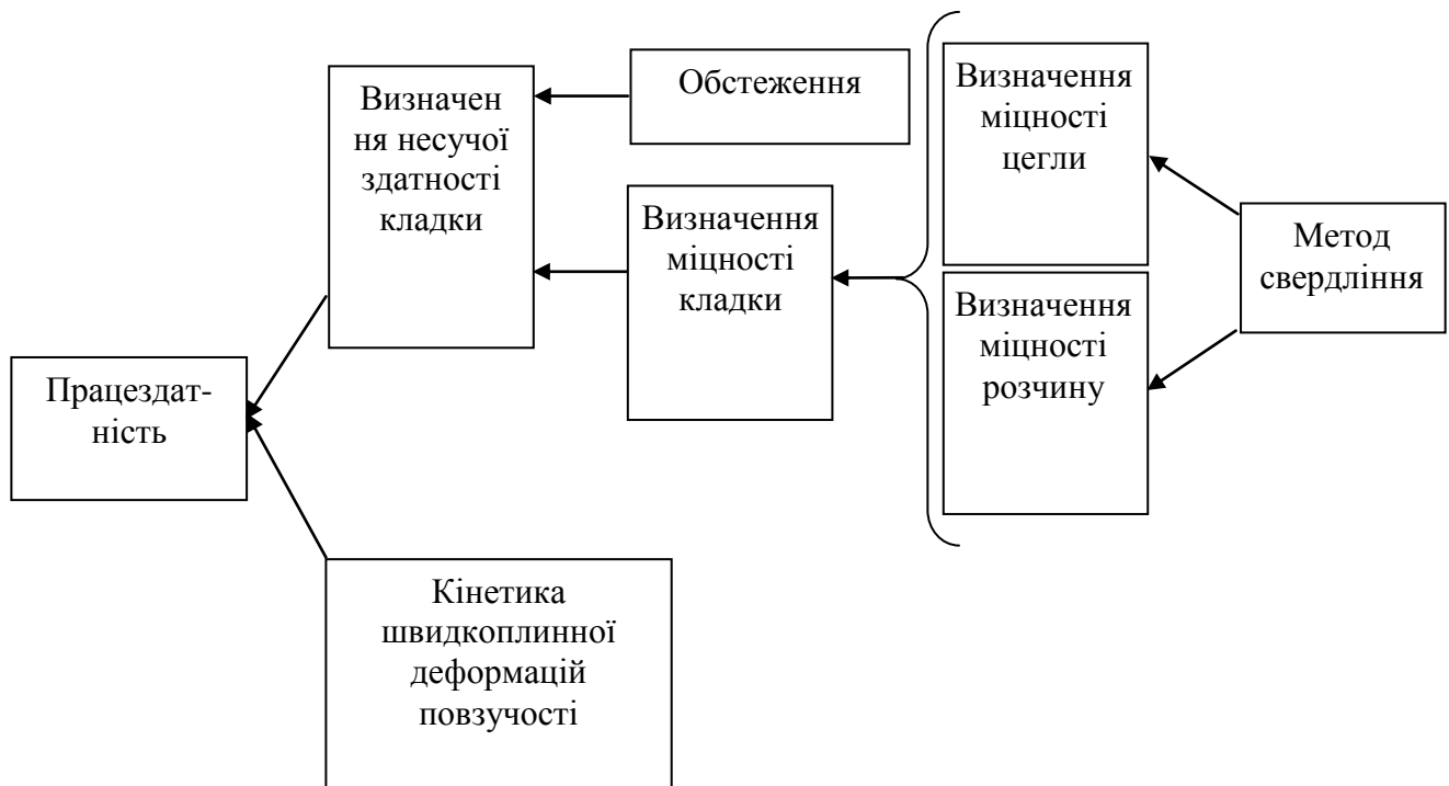
Рис.2. Схема оцінювання працездатності старої цегляної кладки
