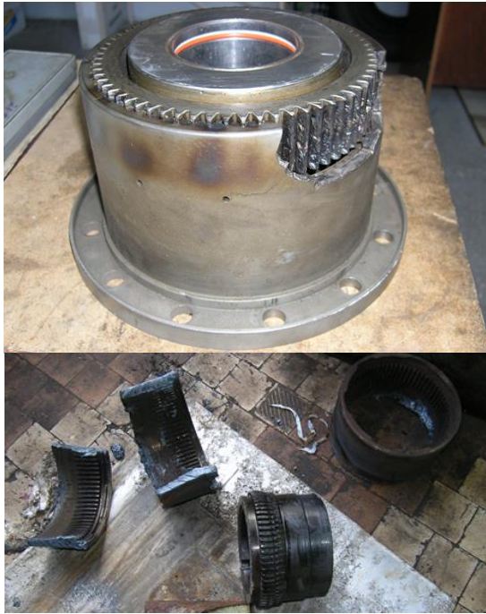
Рис. 3. Руйнування зубчастої муфти мультиплікатора (компресор К-104 виробництва карбаміду)..
