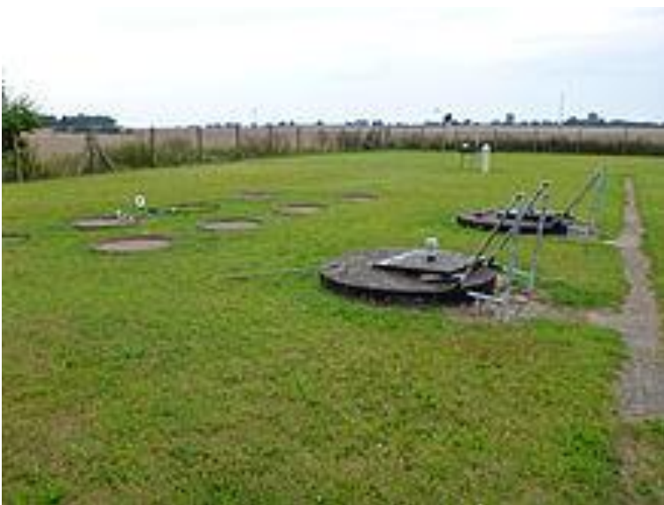
Рис. 2.4 Лізиметр, що має окремий вхід для збору рідини
