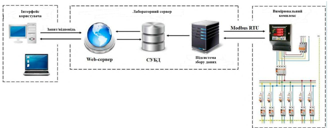
Рис. 2.1. Архітектура досліджуваної інформаційно-вимірювальної системи для моніторингу якості електричної енергії
