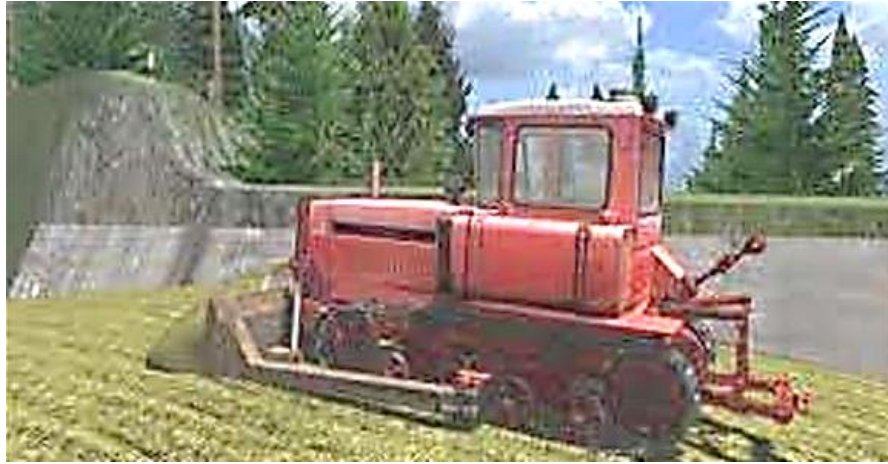
Рисунок 1.13 - Ущільненням маси в сінажній траншеї трактором
