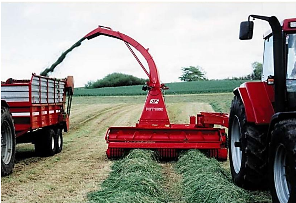
Рисунок 1.6 – Підбирання валків із подрібнюванням та завантаження в транспортний засіб
