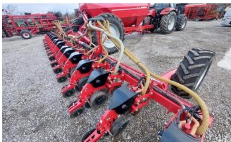
Рис. 1 - Загальний вигляд пневматичної сівалки «Horsch Maestro» з електроприводом висівних апаратів.
