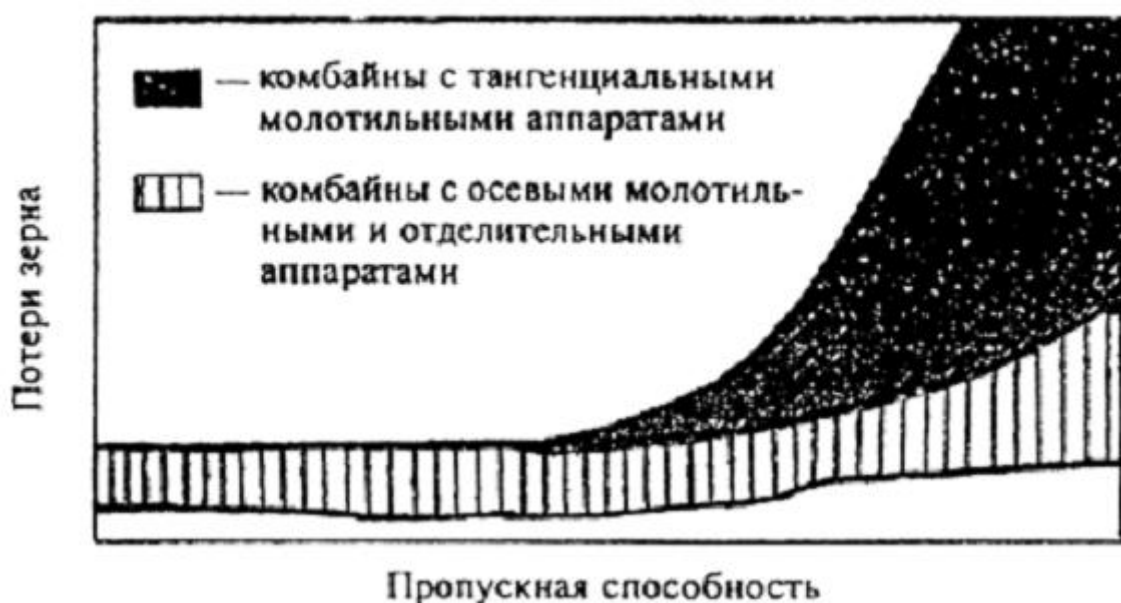
Рис. 70 Взаємозв'язок між пропускною здатністю і втратами зерна в комбайнів з тангенціальними і осьовими молотильними апаратами
