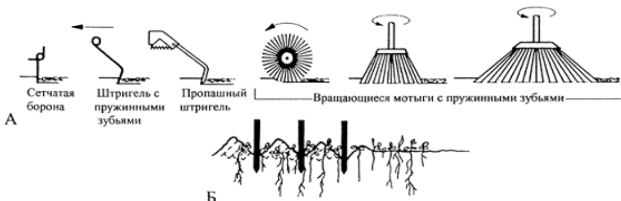
Рис. 52 Знаряддя механічної боротьби з бур'янами у зернових (А) і дія борін (Б)
