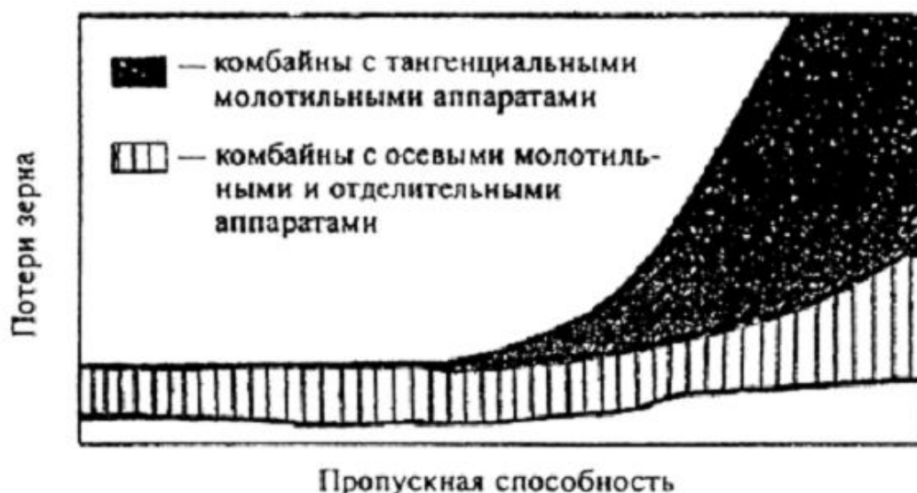
Рис. 17.2 Взаємозв'язок між пропускною здатністю і втратами зерна в комбайнів з тангенціальними і осьовими молотильними апаратами
