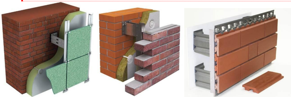
Рис. 1. Вертикальний розріз системи із облицюванням різними матеріалами
