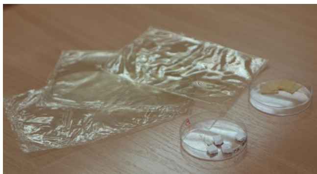
Рис. 2.3. Біорозкладна плівка з хітозану
