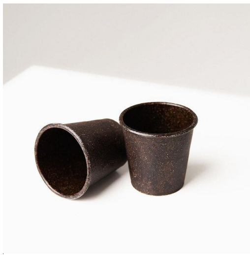
Рис. 2.5. Лабораторні прототипи одноразового біорозкладного посуду rekava з кавової гущі
