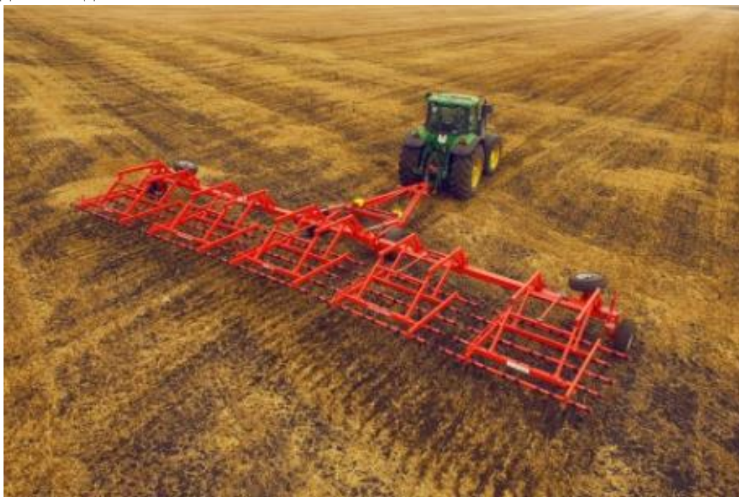
Рис. 1. Боро́на зубова пружинна важка LIRA XL-21 бренду «Лозівські машини».
