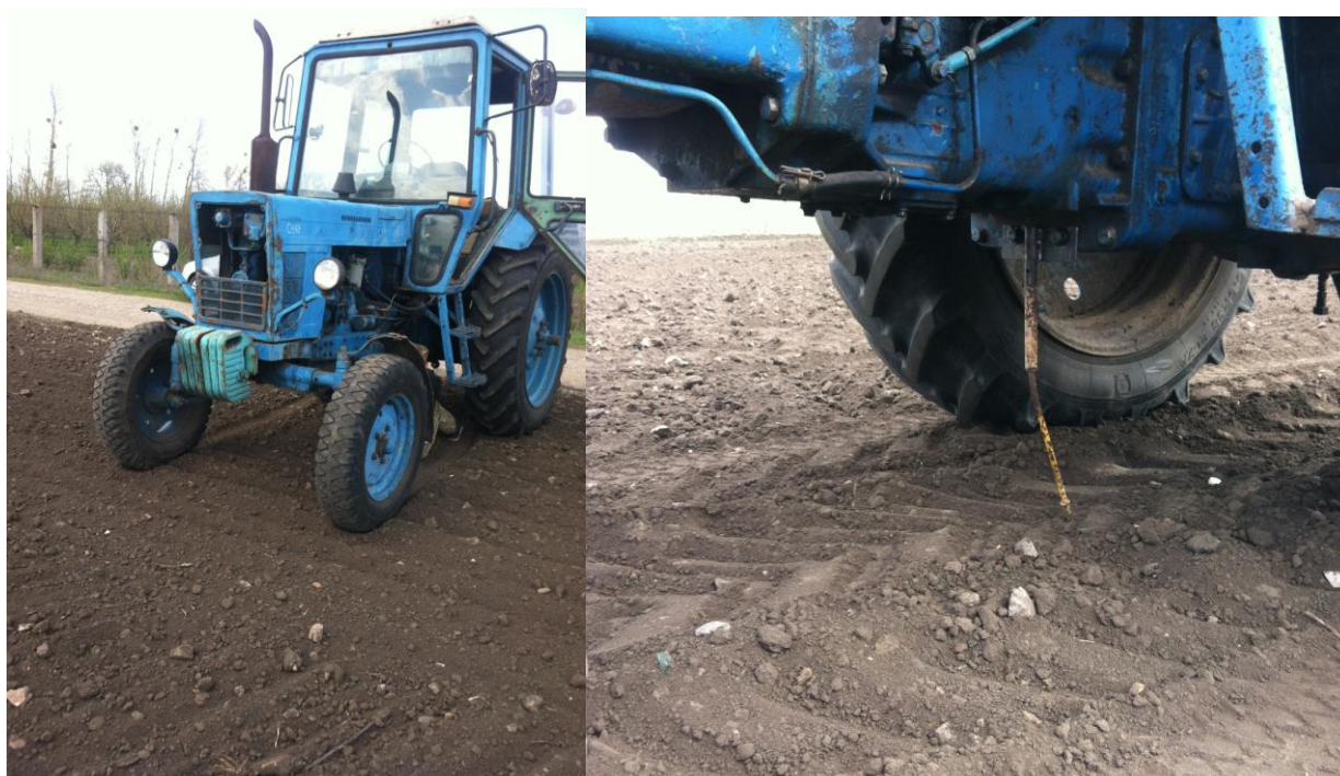
Рисунок 3.2 – Маркер для відтворення траєкторії центра ваги на землі
