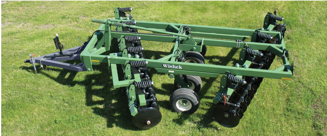
Рисунок 3.2 – Дискова борона Wishek 812N з V-подібною рамою
