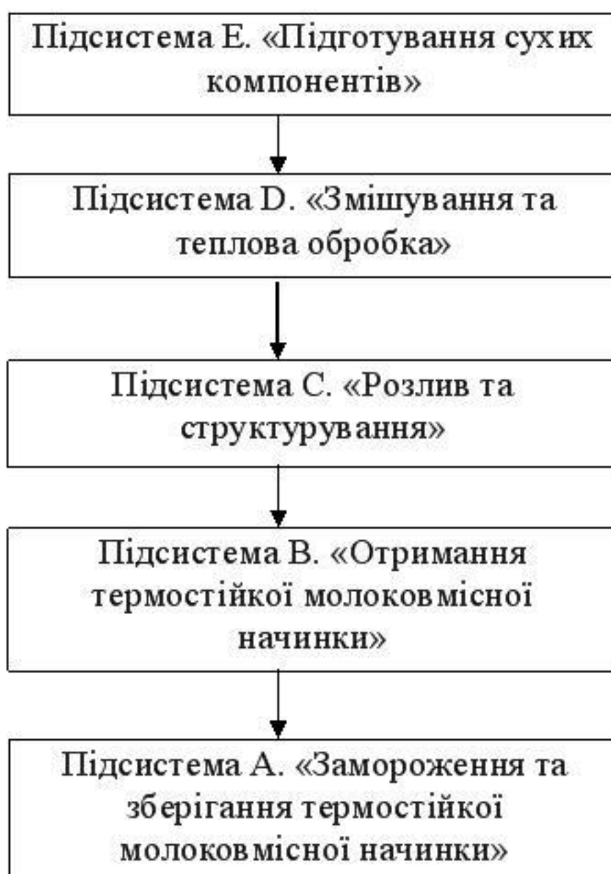
Рис. 2. Технологічна система виробництва термостійких молоковісних начинок «м'яка» і «ніжна».
