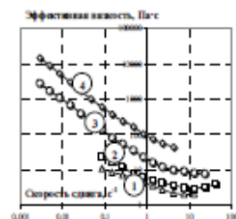
Рисунок – Зависимость эффективной вязкости безбелкового теста от скорости сдвига при содержании ксантана, % к массе кукурузного крахмала: 1 – 0 (контроль); 2 – 0,1; 3 – 0,3; 4 – 0,5
