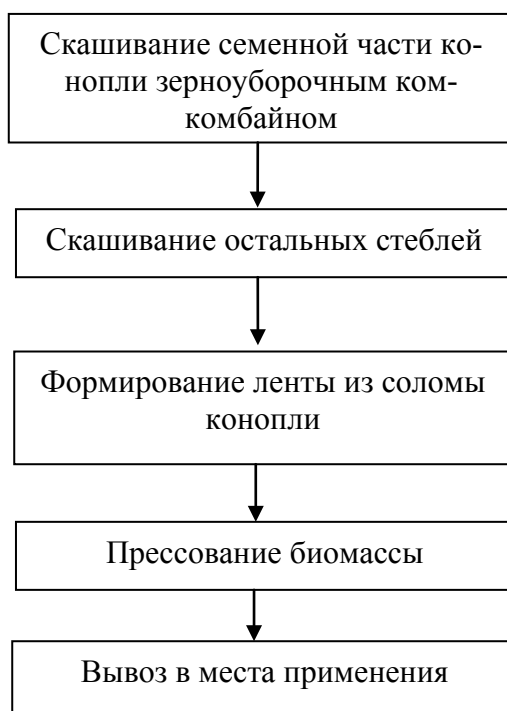
Рис. 1. Принципиальная схема процесса уборки стеблей конопли
