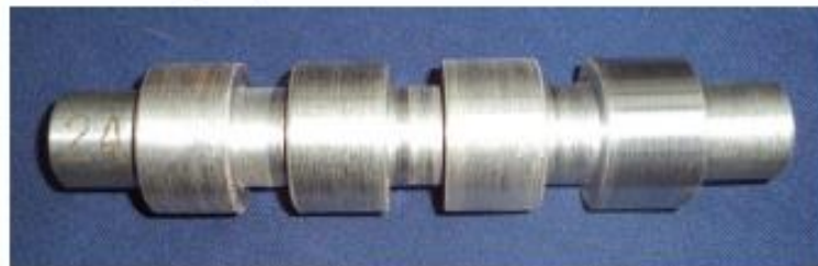
Рисунок 2 – Круглый образец из стали 20
