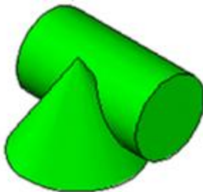
Рис.2.Взаємний перетин конуса та циліндра (тривимірна модель)
