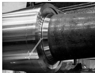
Рис. 1 – Схемы проворота и смещения бандажа относительно оси КГСПВ: а – проворот; б – смещение
