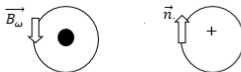
Рис. 2. Схема направления векторов индукционного тока и тока воображаемого витка
