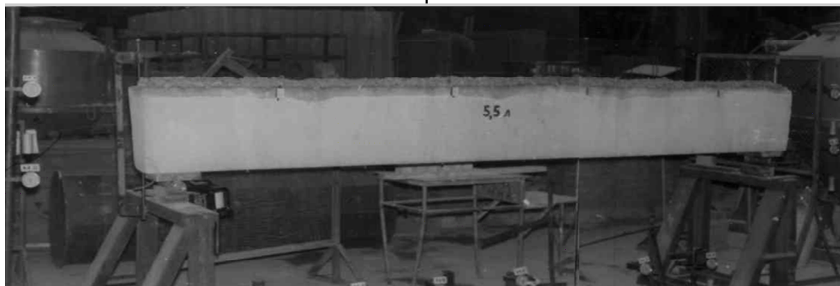
Рисунок 4. Общий вид испытания фундаментной балки ФБ-6-10В1 при увлажнении верхней грани [2] .
