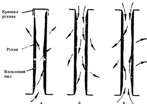
Рис. 3.2. Спосіб підводу газопилового потоку в рукави: а – з нижнім підводом; б – з верхнім підводом; в – з двостороннім підводом
