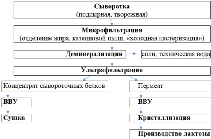
Рис. 8.3. Векторная схема производства КСБ и лактозы
