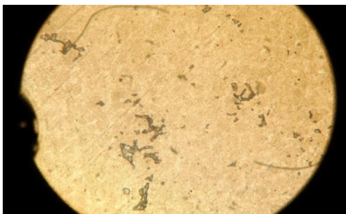
Рис. 5.4. Суміш сухого \text{Fe}_3\text{O}_4 з твердим ПАР в співвідношенні 0,025 г магнетиту : 0,225 г ПАР (дисперсійне середовище - кондитерський жир)
