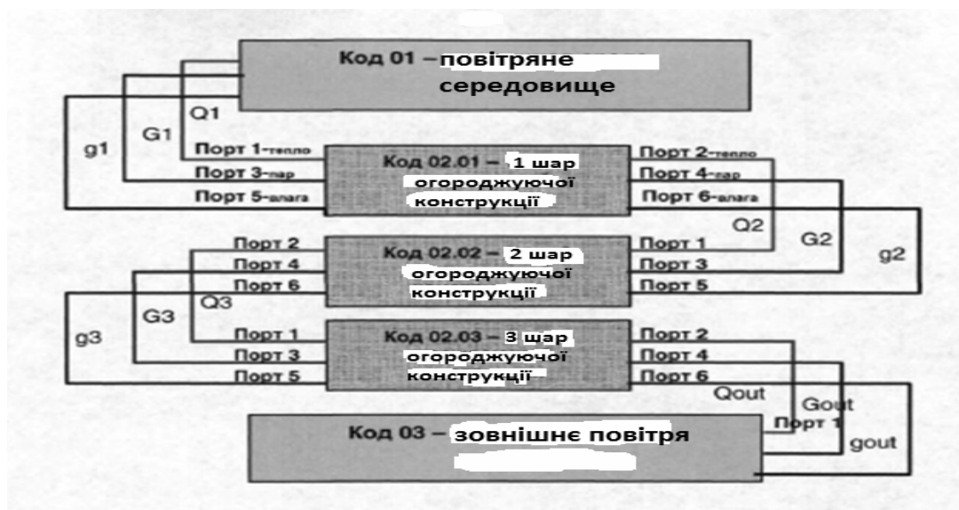
Рис. 2.1. Структурна схема імітаційної моделі тришарової огорожувальної конструкції.
