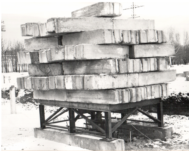
Рис. 4. Металева платформа, завантажена бетонними блоками СП
